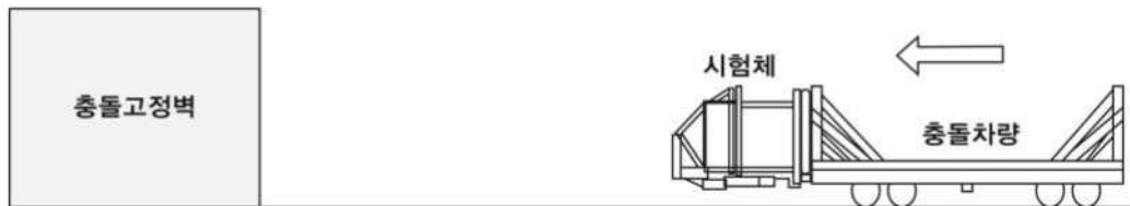
그림 1 고정벽 충돌시험 개략도
