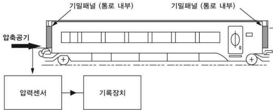
그림 1. 기밀시험(양압)을 위한 측정장치의 설치예시
