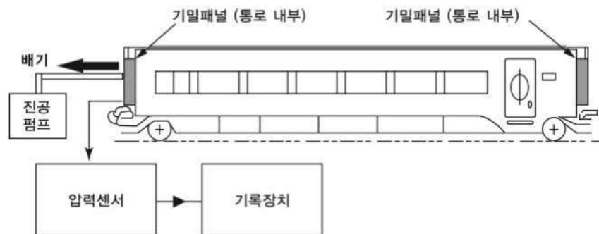
그림 2. 기밀시험(음압)을 위한 측정장치의 설치예시
