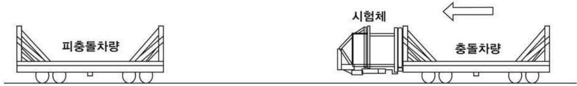
그림 2 차대차 충돌시험 개략도
