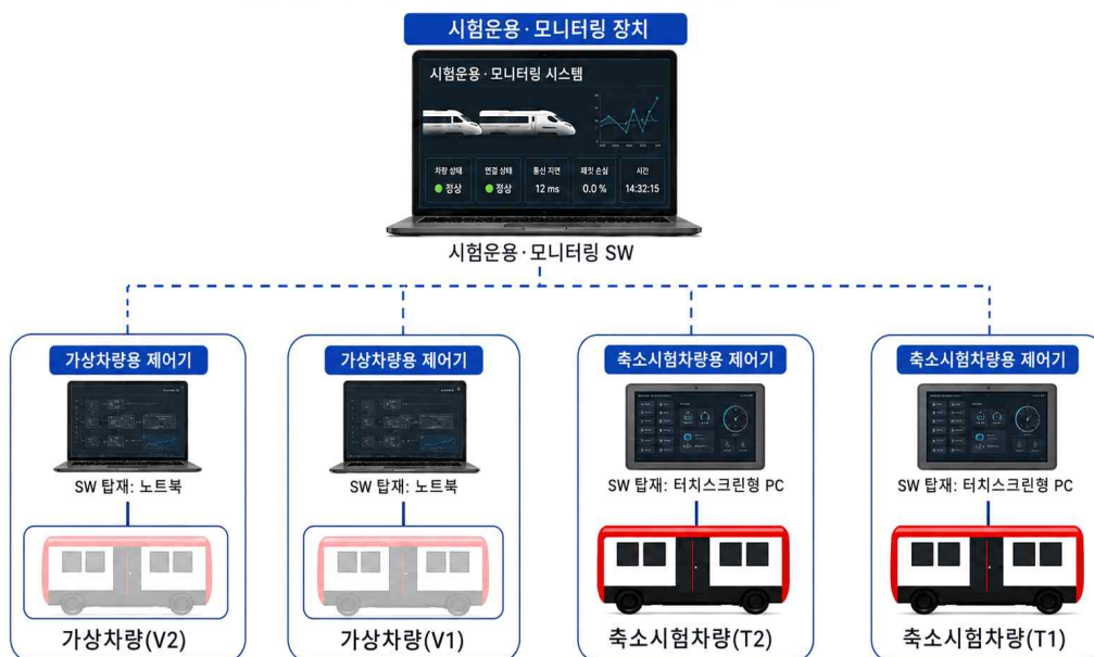
그림 1. 군집제어 통합 검증 시험 환경 개념도
