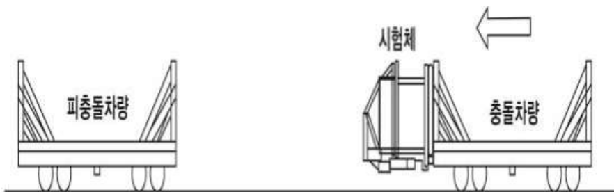
그림 1 고정벽 충돌시험 개략도
