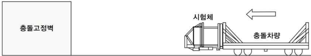
그림 1 고정벽 충돌시험 개략도
