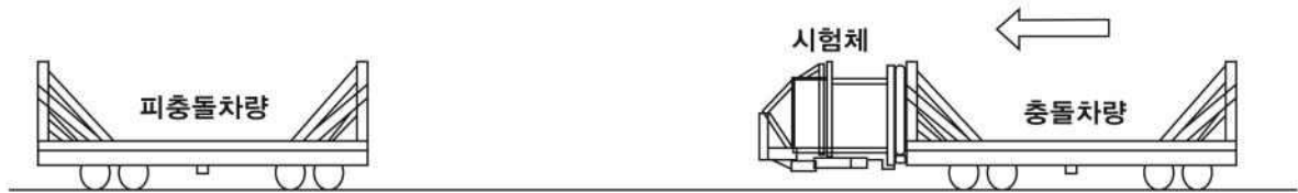
그림 2 차대차 충돌시험 개략도
