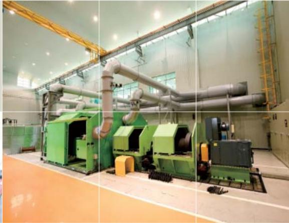
팬터그래프시험기 Pantograph Tester
